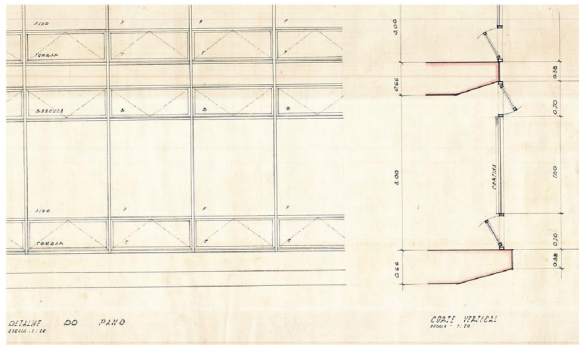
c) Esquadrias Seção típica e detalhe
