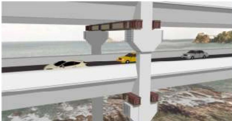
Figura 11 - Projeto de reforço – proposta inicial – vigas metálicas sobre consoles de concreto nos dois tabuleiros
