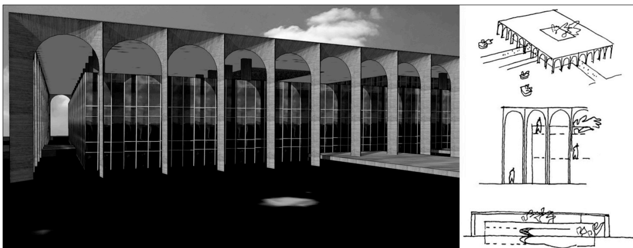
Figura 1: À esquerda, tomada parcial frontal do Palácio do Itamaraty. À direita, croquis feitos por Niemeyer para a obra: acima, perspectiva geral do palácio, ressaltando o volume quadrangular e acessos externos. No centro, relação entre o volume interno recuado e a arcada externa em concreto armado. Abaixo, corte que destaca a horizontalidade do volume total, o jogo de pisos e os diferentes níveis de circulação interna.
